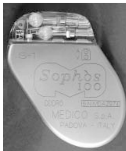
FIGURA 8 Il pacemaker impiantabile Sophòs 100, prototipo della famiglia Sophòs, è uno stimolatore bicamerale rate-responsive a doppio sensore (il sensore emodinamico TVI è integrato da un accelerometro). Il rapporto di blending TVI/accelerometro è programmabile nell'intervallo da 0% a 100%.
