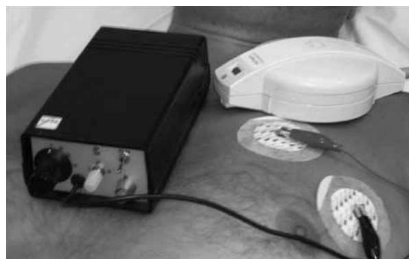
Modalità di collegamento del simulatore di aritmie sopraventricolari (SAS) al paziente
